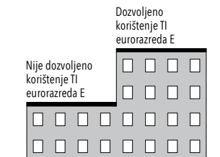
Slika 31 Razlika u primjeni toplinske izolacije (negorivo-gorivo) kod zgrada različite visine zbog mogućnosti prijenosa požara
