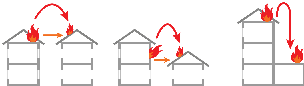
Slika 8 Mogućnost prenošenja požara na zgradu preko krova s vanjske strane
