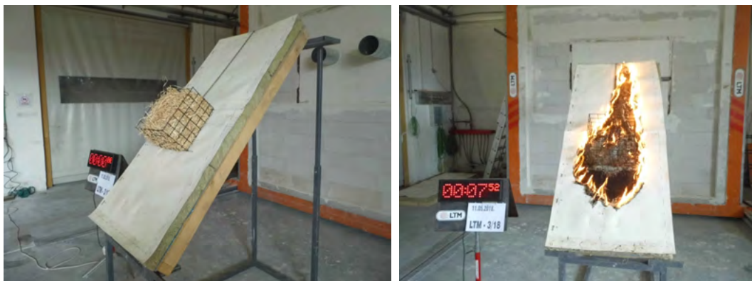
Slika 9 Postav i provedba ispitivanja otpornosti krova na djelovanje požara s vanjske strane gorućim ugarcima na normiranoj podlozi [19]
