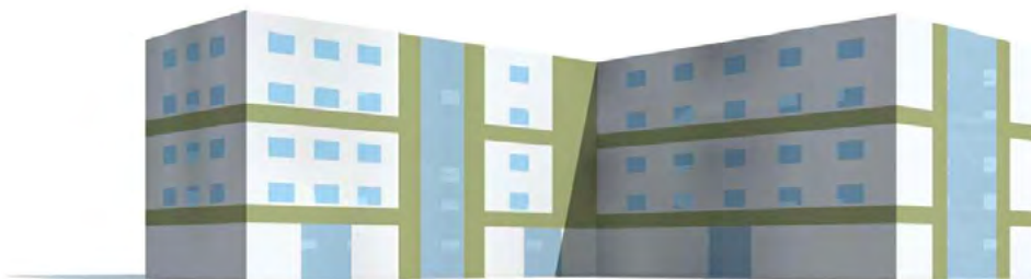
Slika 20 Primjer izvedbe pojaseva od negorivog materijala kod gorive toplinske izolacije pročelja u skladu sa zahtjevima hrvatskog propisa u širinama od 1,2 metra po vertikali te 2 metra i 5 metara kod horizontalnog spoja požarnih odjeljaka [38]
